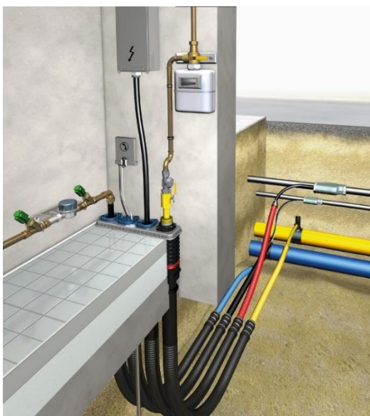
Beispiel Mehrsparten-Hausanschlusseinführung für nicht unterkellerte Gebäude
